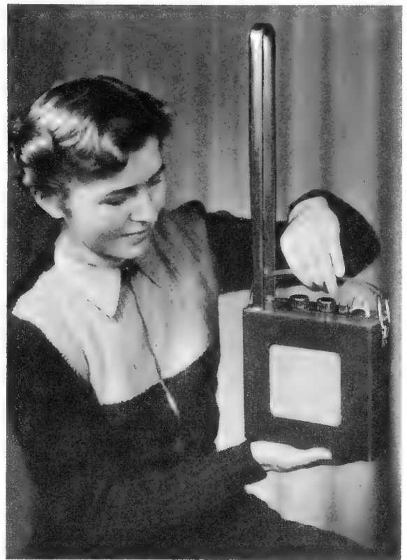
Das Zusatzgerät für Lautsprecher-Empfang für den Taschenempfänger „Bergkamerad“
